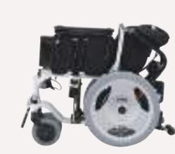
車などへの積載時、背折れ機構でさらにコンパクトな収納が可能
